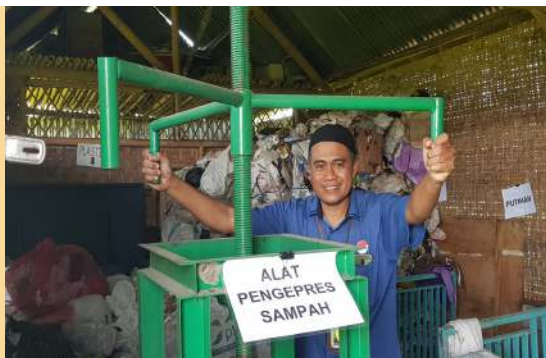
GUDANG. Bambang Suwerda sedang mengoperasikan mesin press sampah di gudang sampah Bank Sampah Gemah Ripah.
